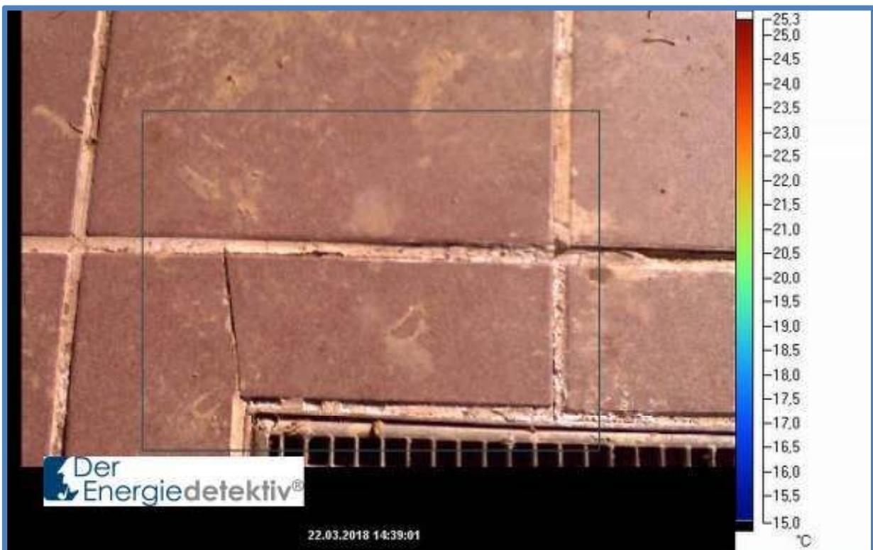
*Bild 193 und 194: Wärmebild einer etwas verschmutzten Keramikfliese, die sich im warmen Bereich vom Betonuntergrund gelöst hat. Aufgrund des isolierenden Luftspalts wird der betroffene Fliesenbereich wesentlich wärmer*
