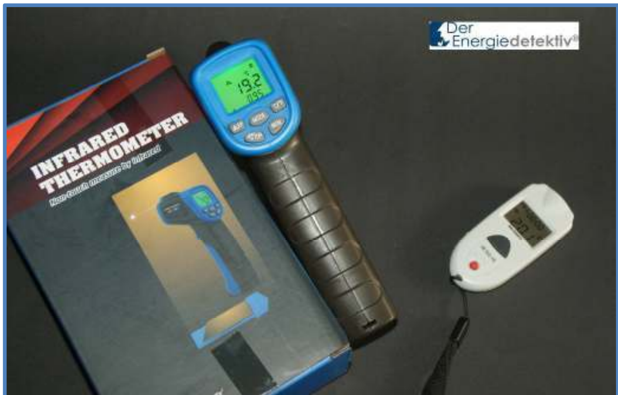
Bild 87: einfache Infrarot-Messgeräte zur Temperaturmessung gibt es bereits um wenige Euro. Damit können Sie Oberflächentemperaturen über kürzere Distanzen an Wänden, sonstigen Oberflächen oder Bauteilen messen
