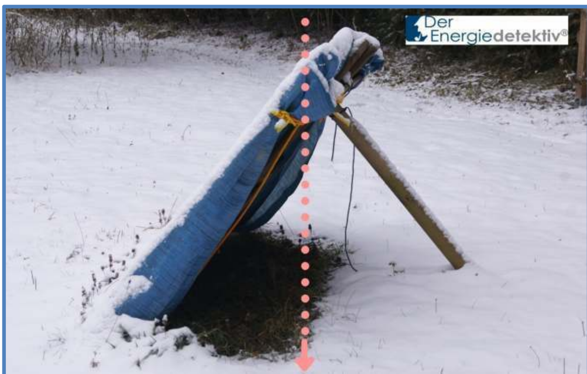
Bild 93: eine mit einer Plane überdeckte Holzpalette wurde im Garten schräg aufgestellt. Der Schneefall macht dann den Umverteilungseffekt sowie die Gewinnzone und die Verlustzone optisch erkennbar
