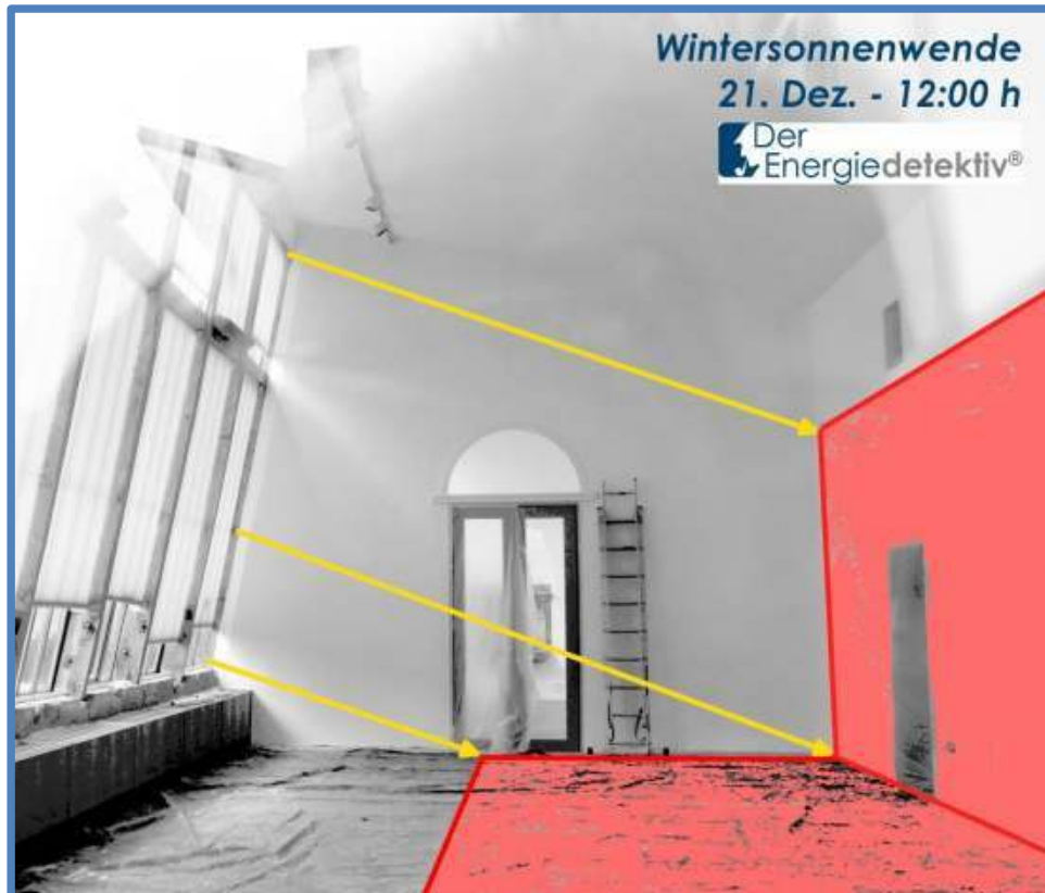
Bild 17: die Gesamtleistung im Winter setzt sich aus der Absorption im Bodenbereich und an der Wand zusammen
