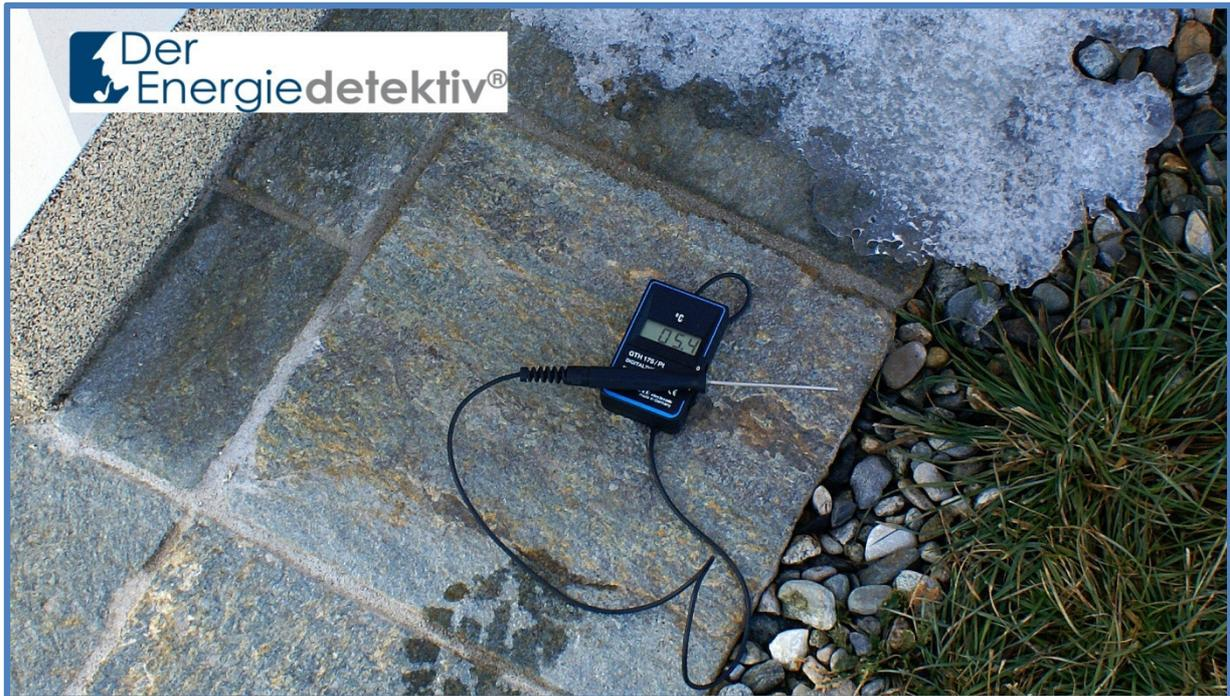
Bild 12-8: Messung der bodennahen Lufttemperatur im Schatten der Kapelle
