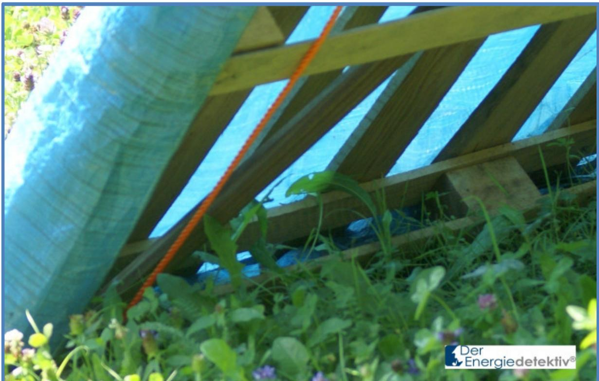
*Bild 8-46: Bei starkem Sonnenschein sieht man, dass die verwendete Abdeckplane etwas Licht immer noch durchlässt. Solarzellen hingegen sind undurchlässiger*
