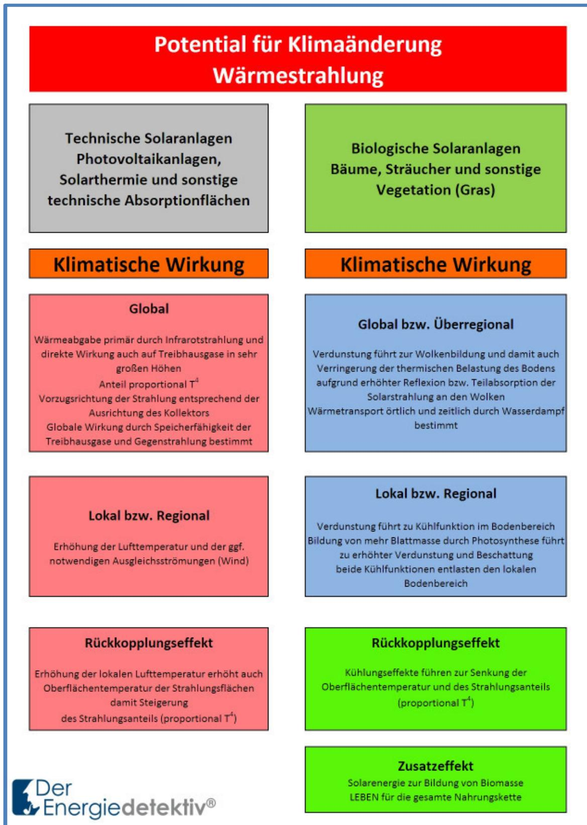
Bild 8-133: Die Strahlungsleistung steigt mit der vierten Potenz der Temperatur. Höhere Oberflächentemperaturen an Solaranlagen lassen daher eine massive Verstärkung der Wirkung auf Treibhausgase erwarten. Dieses Schema fasst die von uns vermuteten Auswirkungen auf regionales und globales Klima zusammen.
