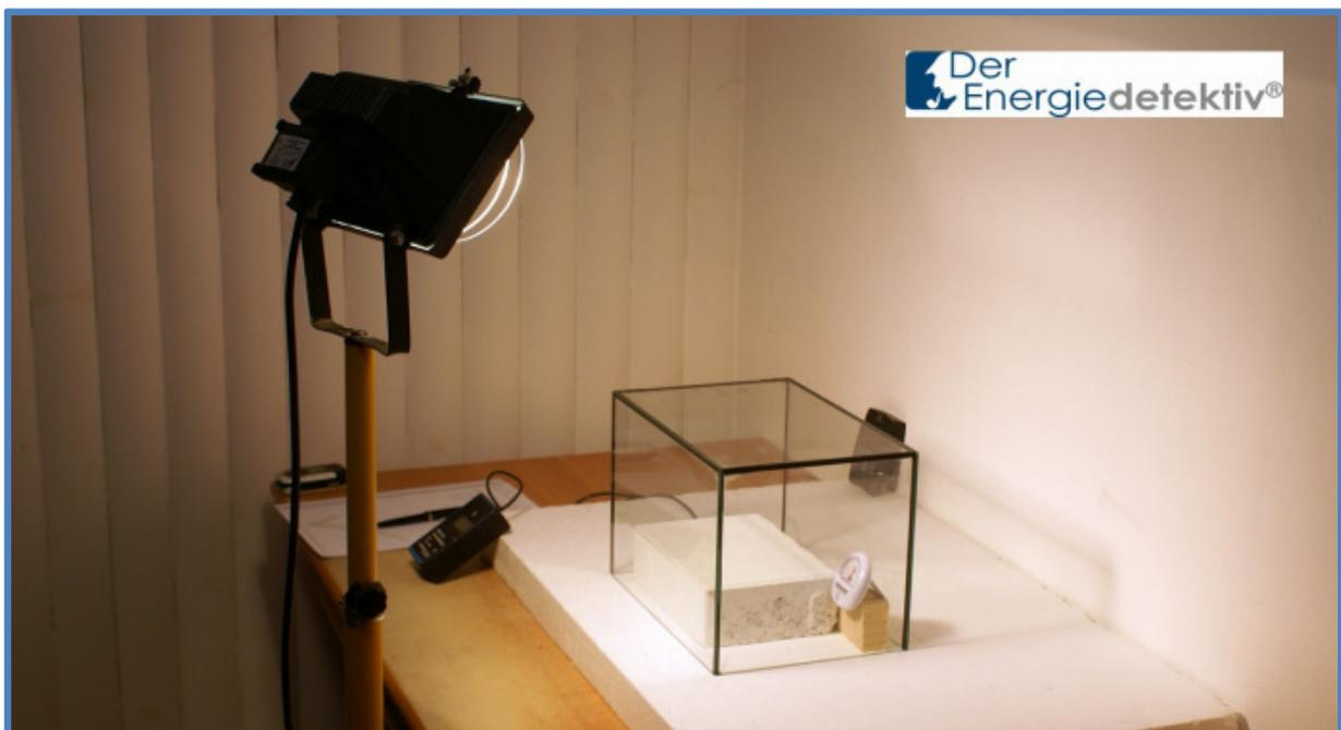
*Bild 8-126: Versuchsaufbau zur Simulation des Treibhauseffektes für unterschiedlich absorbierende Körper.*
