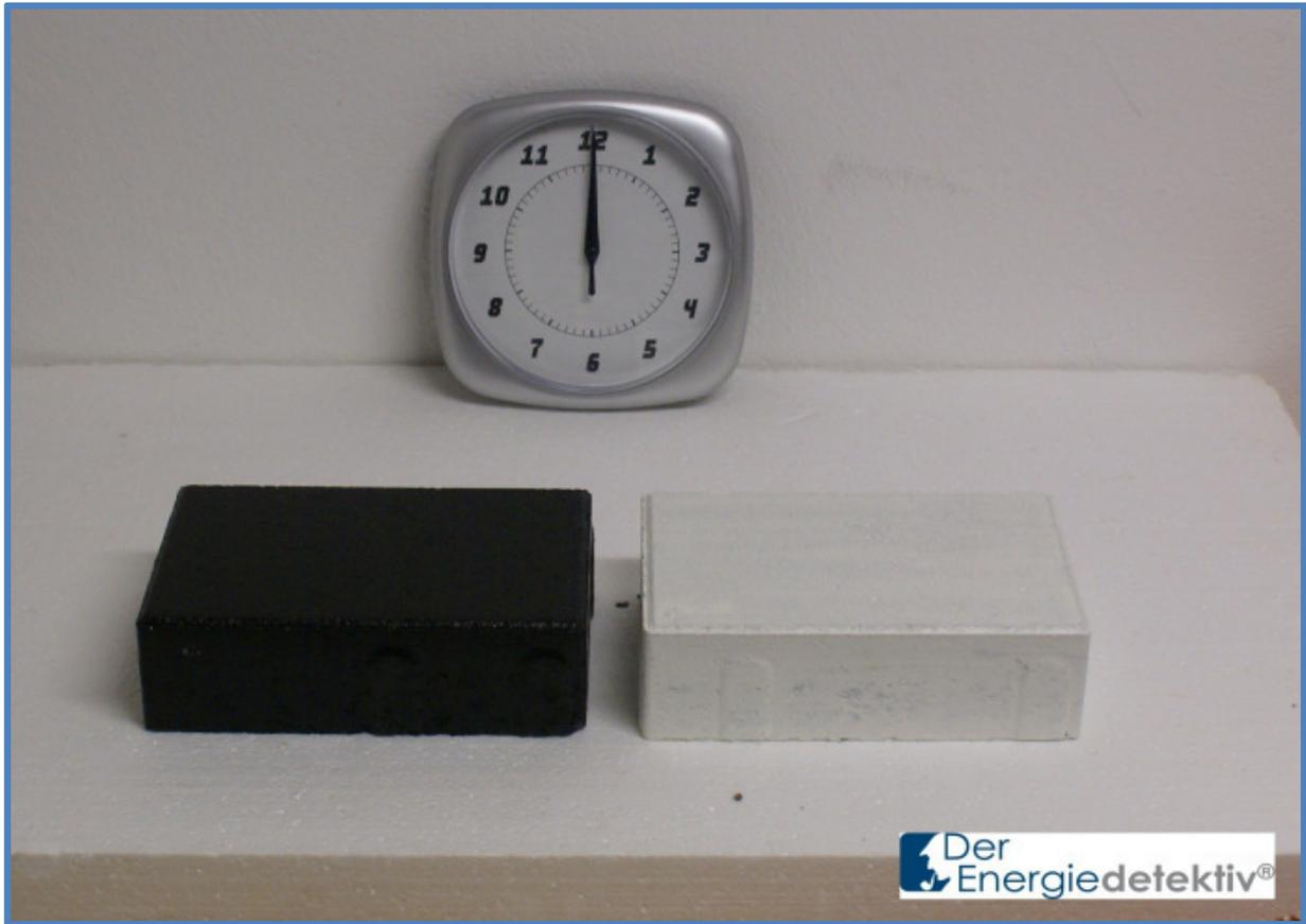
*Bild 8-127: prinzipieller Aufbau zur Messung des Absorptionsverhaltens ohne Glashaushaus: beide Körper befinden sich auf einer Dämmplatte. Zur Messung werden die Zeit der Strahlungseinwirkung und Wärmebilder erfasst.*
