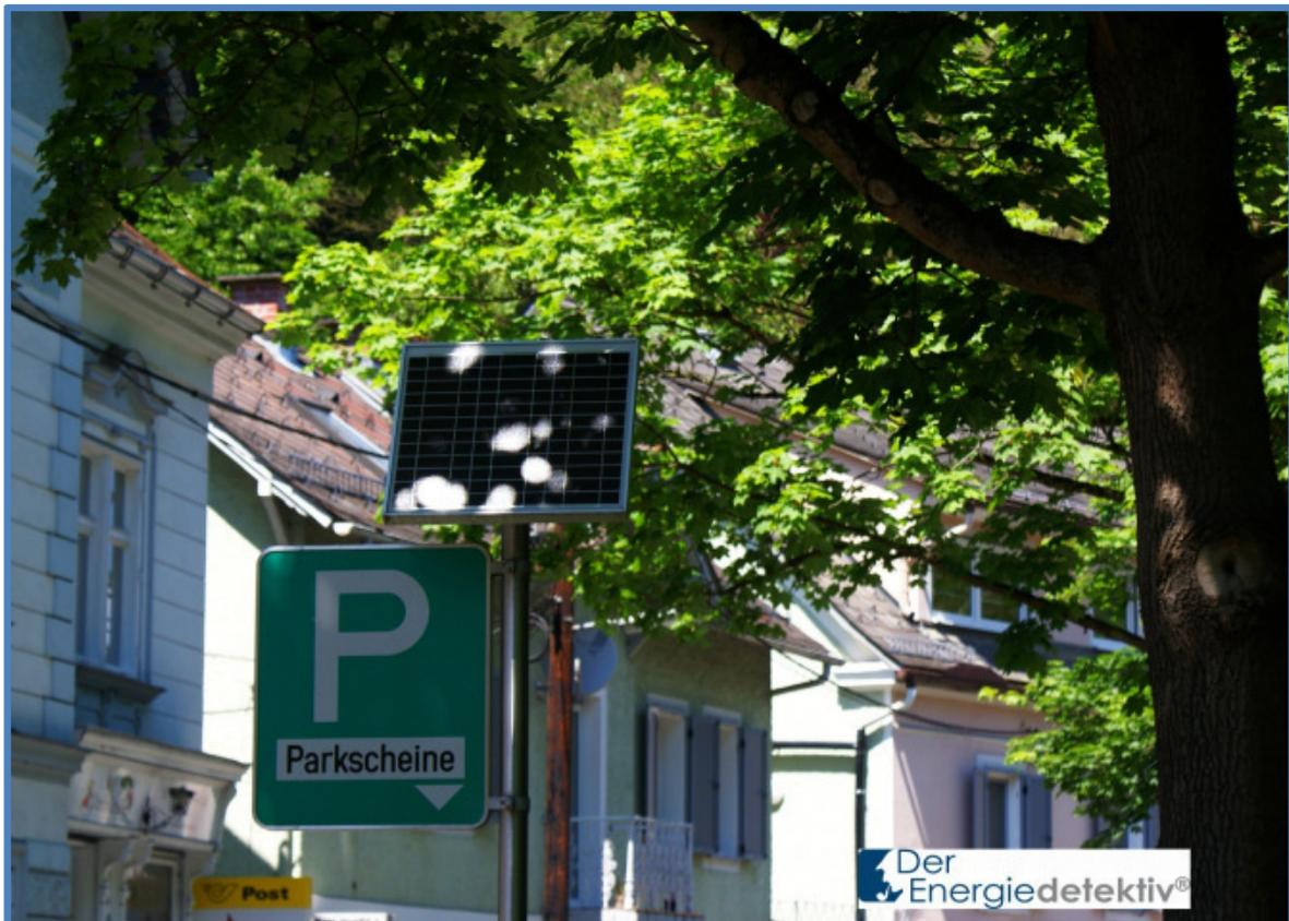
*Bild 8-24: Schattendasein der Solarzellen eines Parkautomaten im öffentlichen Bereich der Stadt Graz*
